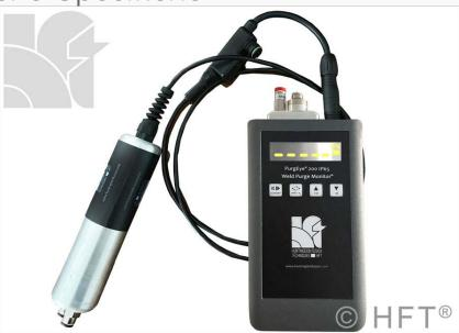
L'Argweld® PurgEye® 200 IP65 Weld Purge Monitor® Ricaricabile può essere utilizzato con qualsiasi Sistema di Spurgo per Saldatura di Tubi o Tubazioni; con qualsiasi Flexible Welding Enclosure® e Camera di Spurgo di Saldatura. Il PurgEye® 200 può essere utilizzato per qualsiasi tecnica di spurgo di saldatura per misurare i livelli di ossigeno da 1.000 ppm a 1 ppm (precisione di 10 ppm).
