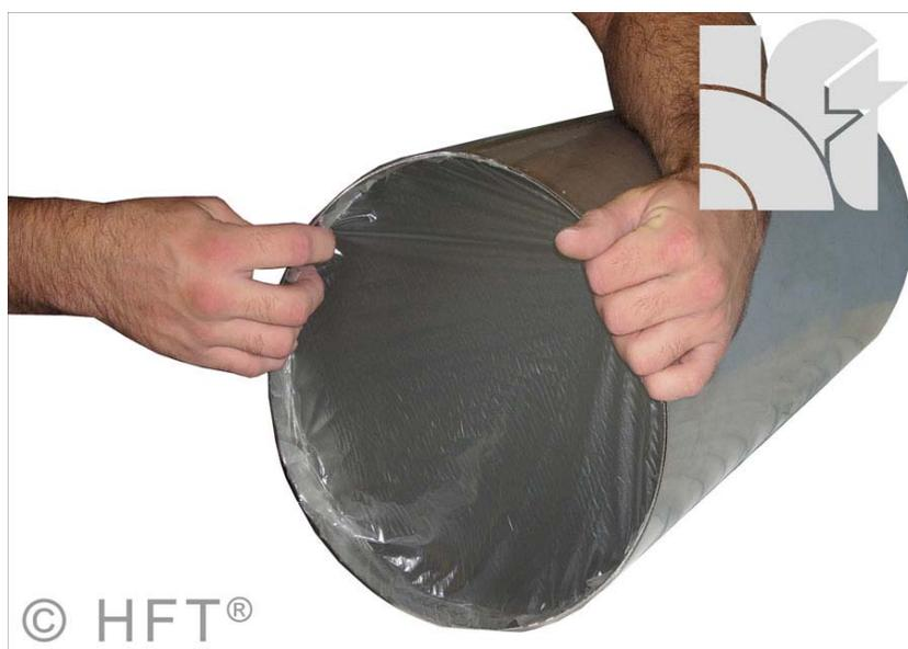
I prodotti di carta per spurghi di saldature e i coni di carta da spurgo rilasciano fibre di carta che non permettono di ottenere spurghi di saldatura puliti.
